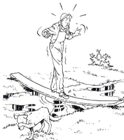
Figuur 2: Voor de bruikbaarheid moet een constructiedeel afdoende stijf zijn.
