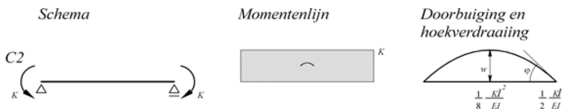
Figuur 33: Extra te gebruiken formules voor een tweezijdig uitkragende ligger.
