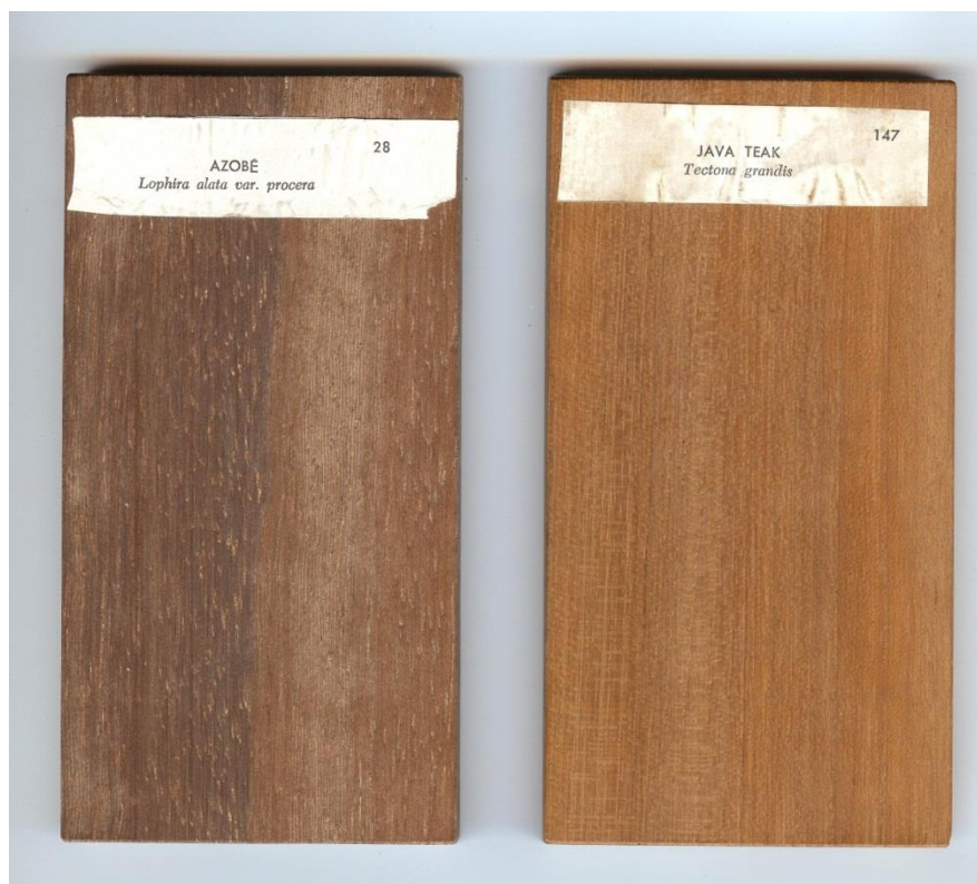
Twee tropische hardhoutsoorten: Azobé, een houtsoort die vaak in de waterbouw wordt toegepast en Java Teak, een houtsoort, die door zijn mooie kleur en tekening in de meubelbouw en als vloer wordt toegepast.
