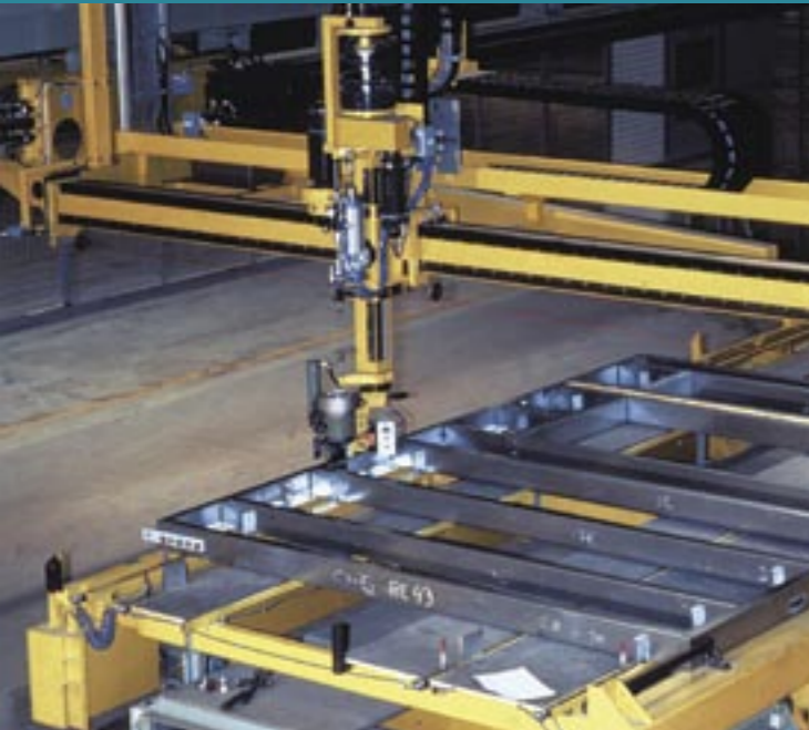
46. Robotgestuurde prefabricage Rautaruukki Oyj (Finland).
